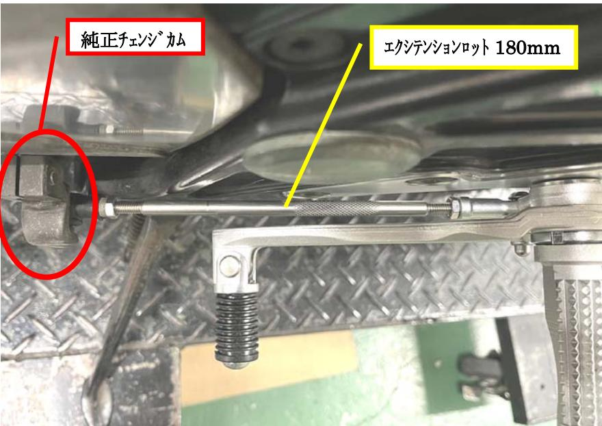
チェンジペダル高さを、エクステンションロッドの長さを調整し好みの高さに合わせる。
