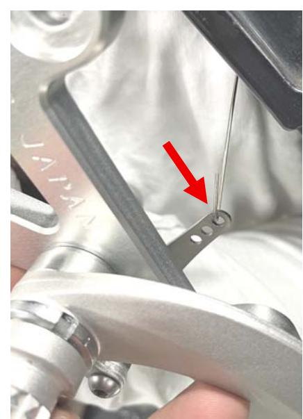
左図の様に、ブレーキスイッチスプリングを取り付ける。
