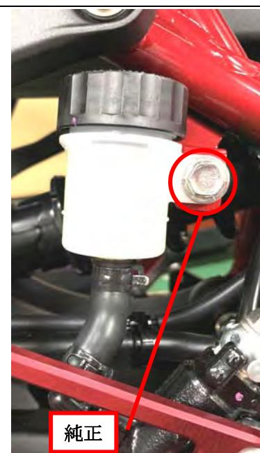
ブレーキペダル穴にジョイントカラーを入れ、丸キャップボルト **M8×45** で、13.5mm厚カラーとSPワッシャー挟みピロボルに取り付け、マスターシリンダーとブレーキペダルを接合する。
