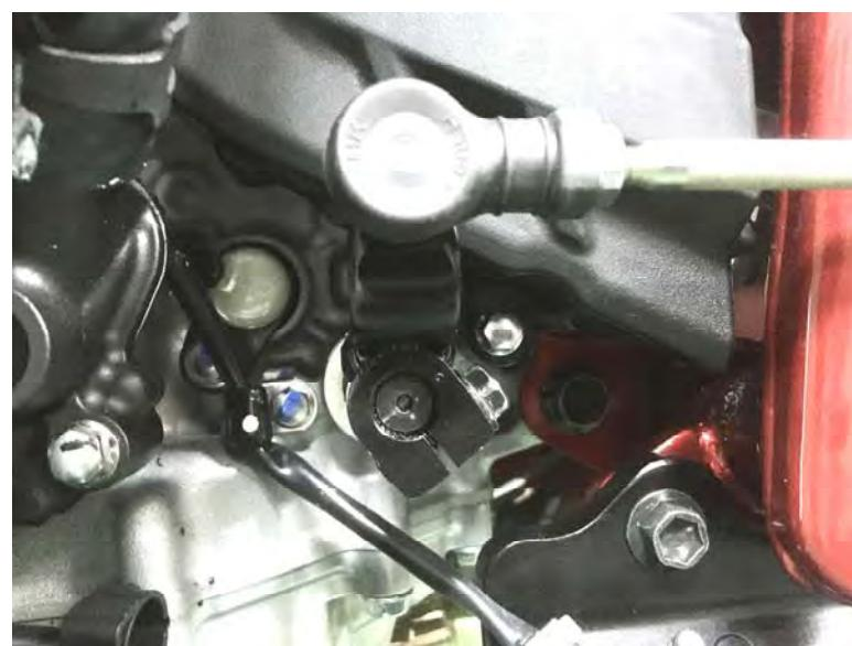
左図の様に、純正のチェンジカムを上下逆に取り付ける事で、逆チェンジ仕様に変更が可能です。
