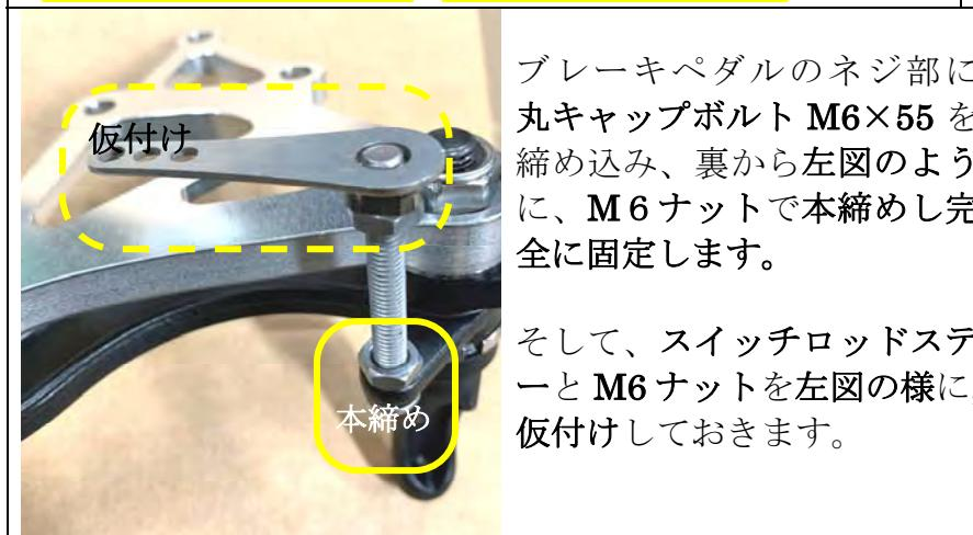
ブレーキペダルのネジ部に丸キャップボルト M6×55 を締め込み、裏から左図のように、M 6 ナットで本締めし完全に固定します。
