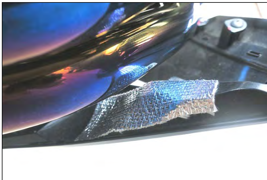
左側アンダーカウルの遮熱シート貼り付け例
