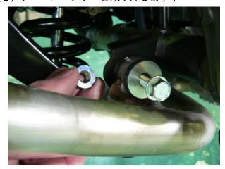
※ノーマルマフラー(上の写真)テールパイプステー取り付けナットは ナサートマフラー取り付けに使用します!
