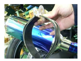
(8) サイレンサーバンドを写真のように、付属の はめ込みカラーをサイレンサーバンドにはめてから 付属のM8ボルト、ナット、 t 20カラーで取り付けます!
