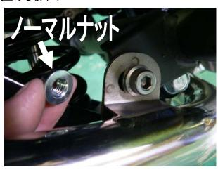
(6) 写真のように、サイレンサー取り付け部分のバンパーを 付属のカラーに取り換えて(表裏) アルミステーを付属のM10ボルト、ナット、ワッシャーで取り付けます!
