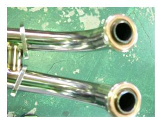
(4) 車体にエキパイを取り付けます。(ノーマルエキパイナットを使います) 02センサーを取り付けます!
