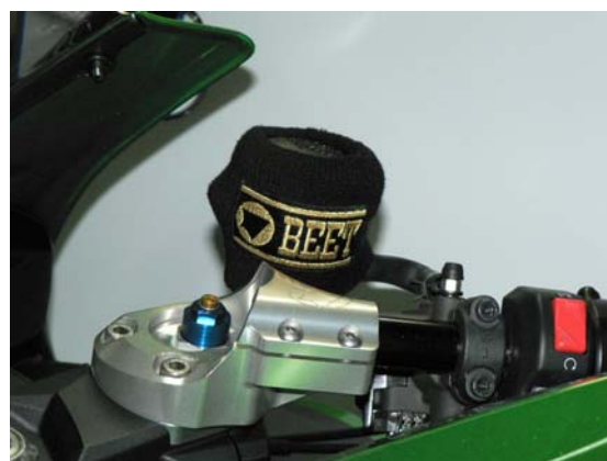
ブレーキマスターリザーバーカップのカバーとしての使用例
