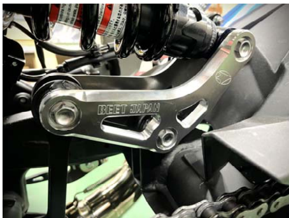
高強度のジュラルミン材削り出し
