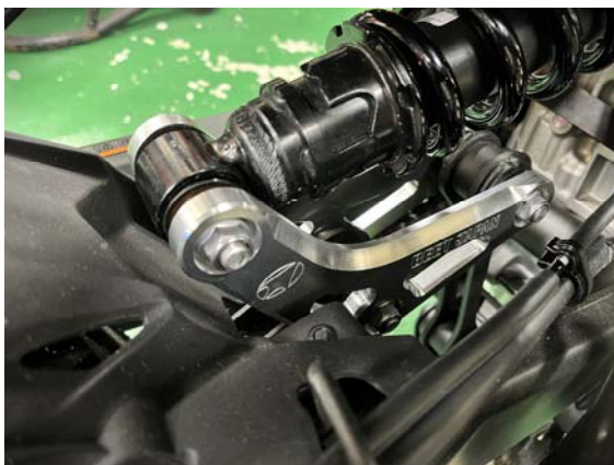
高強度のジュラルミン材削り出し
